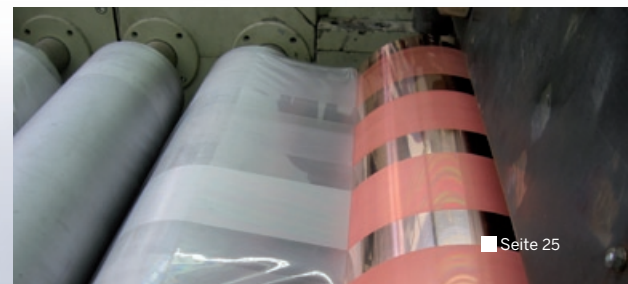
Prägeversuch zur Heißprägung von PC-Folien (Quelle: Fraunhofer UMSICHT)
